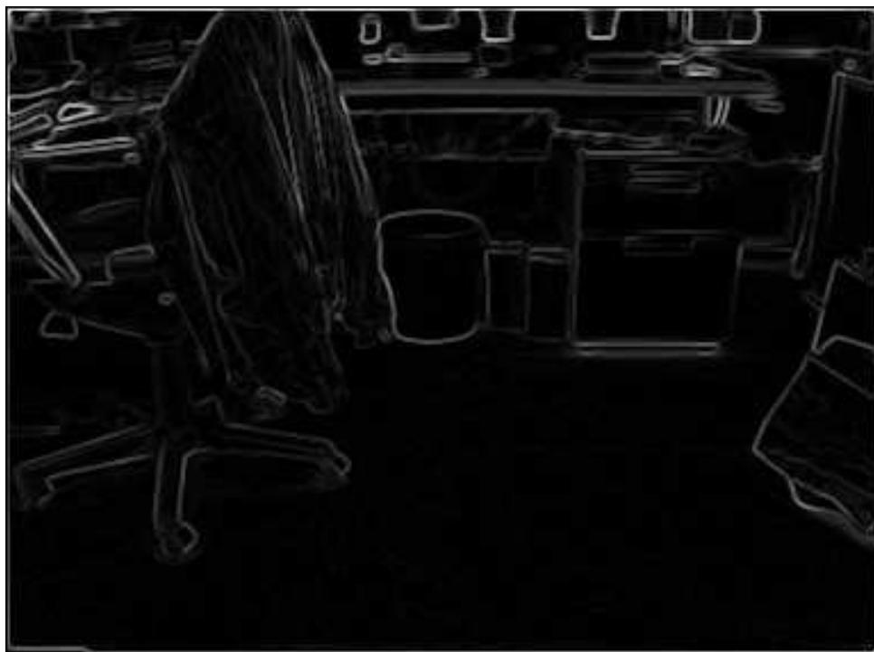
Abbildung 6.11: Szenario III – Kantenextraktion der Originalaufnahme
