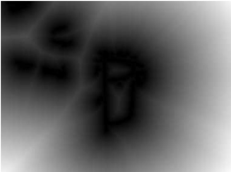
Abbildung 6.7: Szenario II – Distanztransformation des binarisierten Kantenbildes
