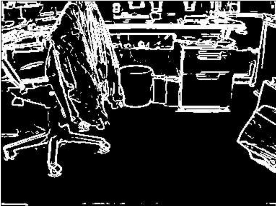
Abbildung 6.12: Szenario III – Binarisiertes Kantenbild
