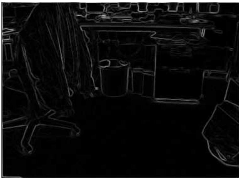
Abbildung 6.26: Szenario V – Kantenextraktion der Originalaufnahme
